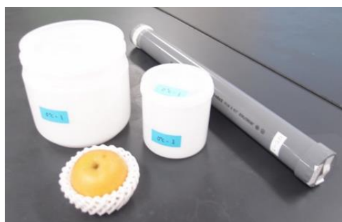
呼吸量測定に用いた小型容器
