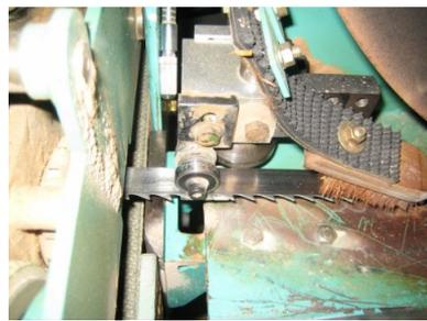
写真-3. エア吹き付け装置と鋸屑かき出しブラシ
