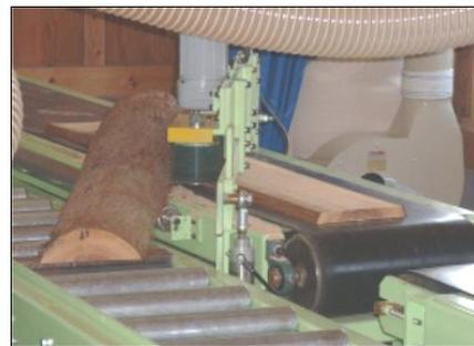
写真-8. 仕分け装置（回転ベルト併設）
