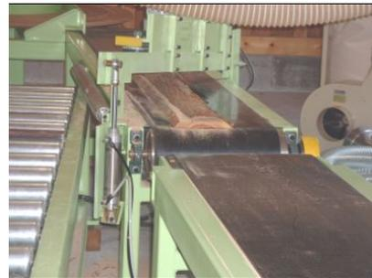
写真-7. 仕分け部の引き上げ装置
