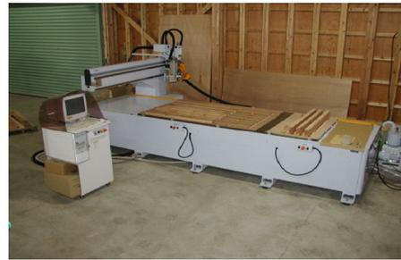
写真-11. 改良した多軸穴開け機
