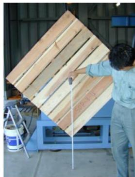
写真-6. 落下試験の様子
