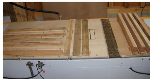
写真-12. 多軸穴開け機の作業スペース (左: デッキボード、右: 桁材)
