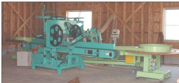
写真-1. 試作したベルトコンベア式短尺材製材ライン
