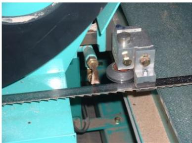
写真-4. エアと潤滑油の吹き付け装置
