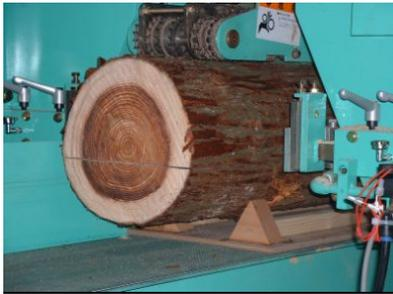
写真-10. 試作治具を使った製材
