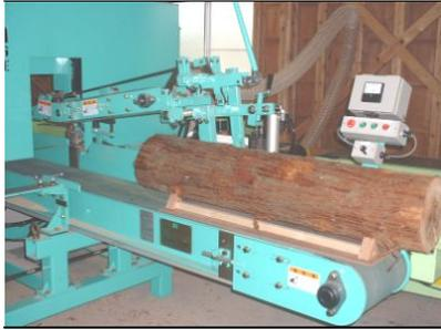
写真-9. 試作した丸太固定治具上の丸太
