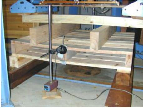
写真-5. 実大パレットの曲げ試験の様子
