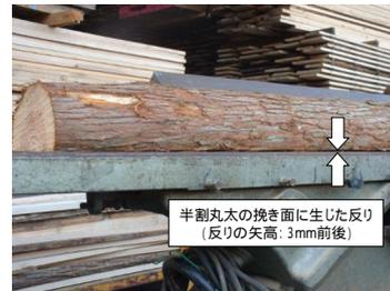
写真-8. 丸太挽き面に生じた反り
