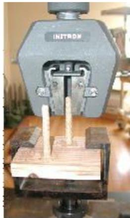
写真-4. ダボの引抜試験
