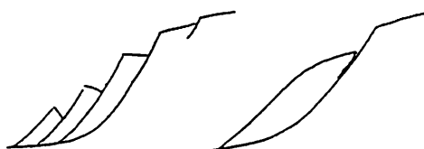
第34図 塊状崩土
