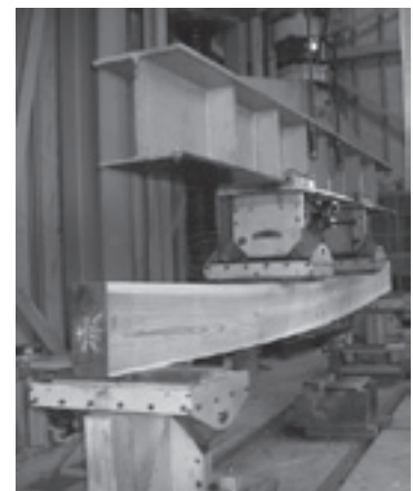
図-3 平角の実大曲げ試験
