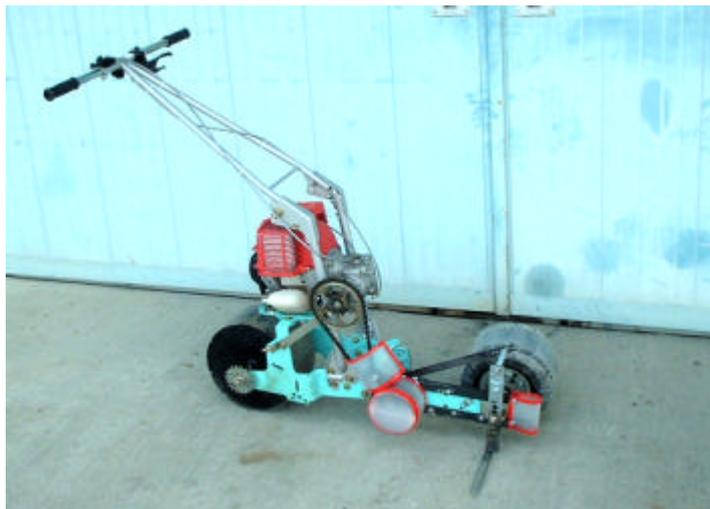
写真1 開発した野菜根切り収穫機
