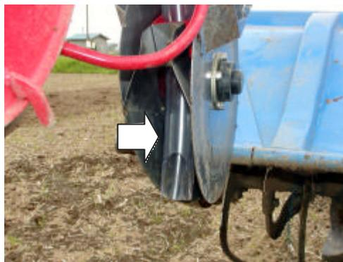
写真2 種子繰出パイプ延長による播種高さの調整
