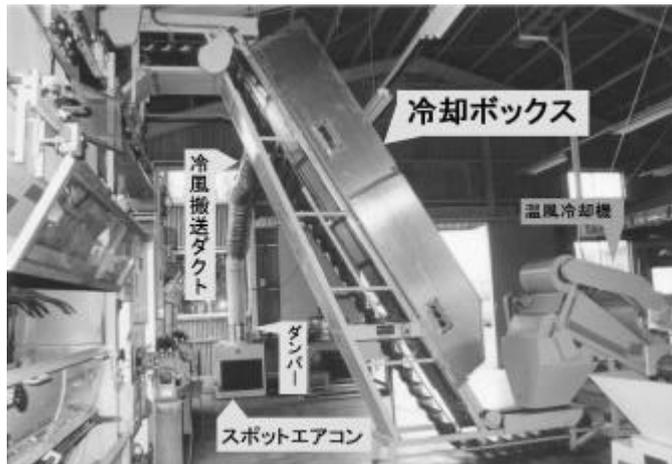
写真1 蒸葉強制冷却機
