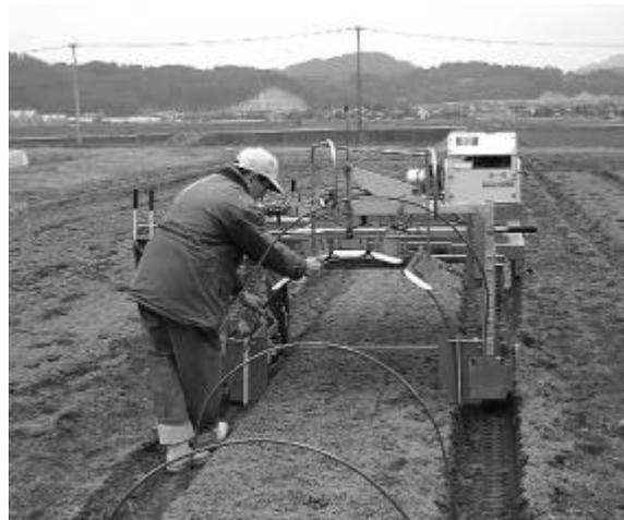
図1 A社製支柱打込機のトコ支柱打ち込み作業
