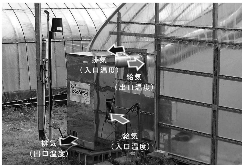
第3-2図 供試した熱交換換気装置の外観と給排気の流路
