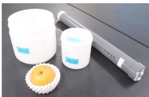
呼吸量測定に用いた小型容器
