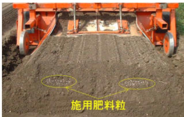
写真1 開発した幅広型肥料吐出管
