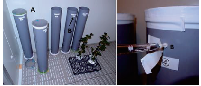
第 1 図 呼吸速度・エチレン発生速度測定用容器
