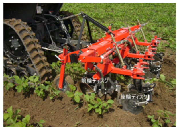
第 1 図 ディスク式中耕除草機
